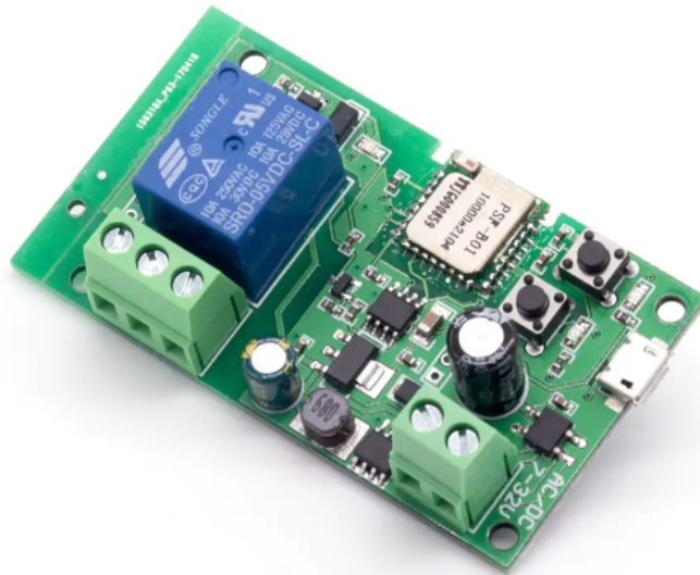
Рисунок 3.13 - Фотографія реле, яке буде використано у розумній розетці
