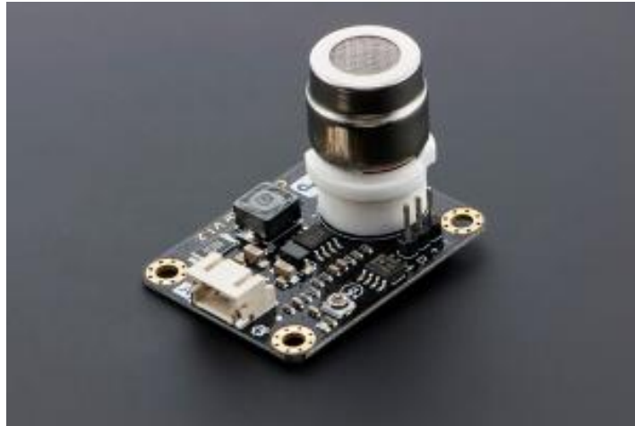
Рисунок 2.4 - Приклад датчику CO2 на базі DFRobot
