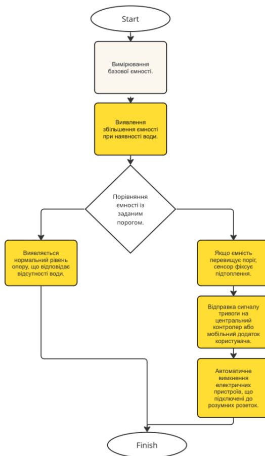
Рисунок 2.3 - Блок схема сенсора підтоплення за ємнісним методом
