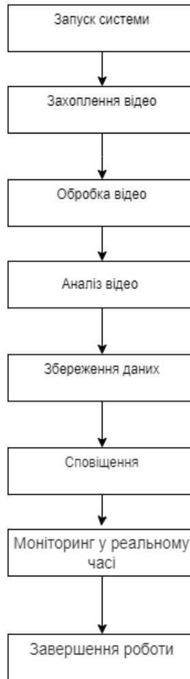
Рисунок 2.7 – Алгоритм коду системи відеоспостереження
