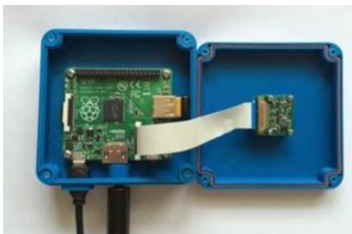
Рисунок 3.24 – Варіант вдосконалення спроектованого апаратно-програмного модулю візуального спостереження в окремому корпусі
