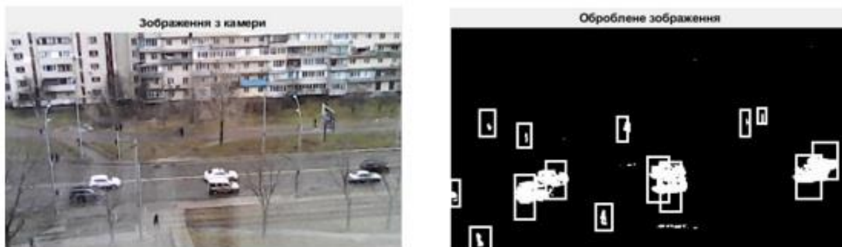
Рисунок 3.20 – Приклад роботи оцінки фону на основі визначення мінімуму або максимуму інтенсивності пікселів з камери при візуальному спостереженні
