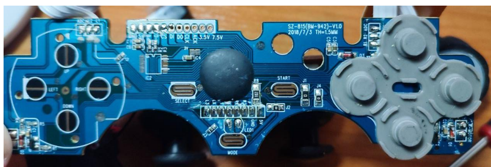
Рисунок 2.1 – Основна плата геймпаду
