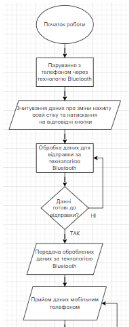
Рисунок 2.11 – Блок-схема алгоритму роботи пристрою
