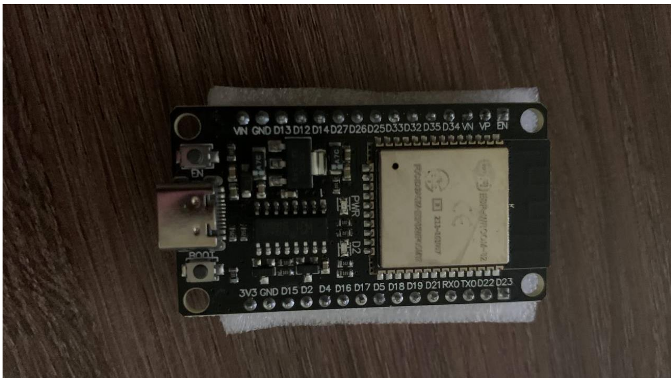
Рисунок 2.5 – Плата ESP32 CH340 Type-C
