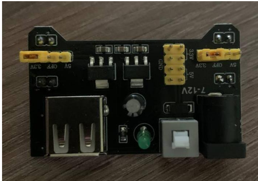
Рисунок 2.8 – Модуль живлення MB-102 (5V / 3.3V)
