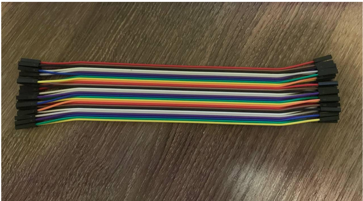
Рисунок 3.3 – вигляд кабелів типу Dupont
