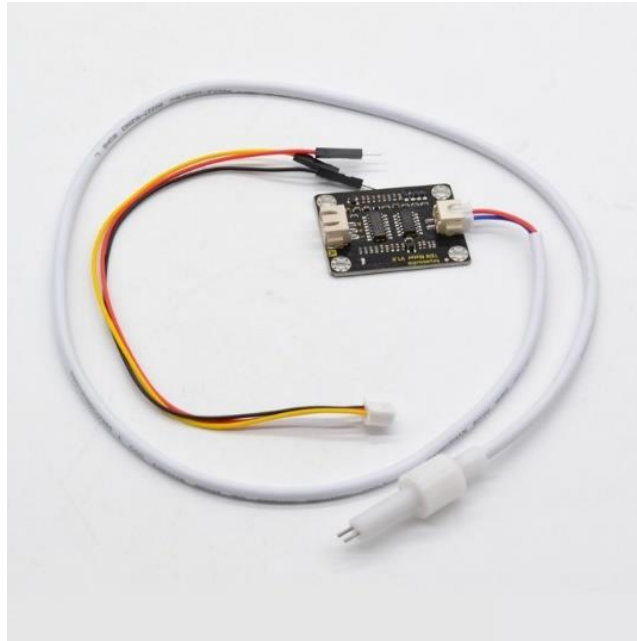
Рисунок 2.3 – Датчик рівня TDS
