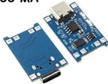
Рисунок 2.24 – Контролер заряду TP4056.
