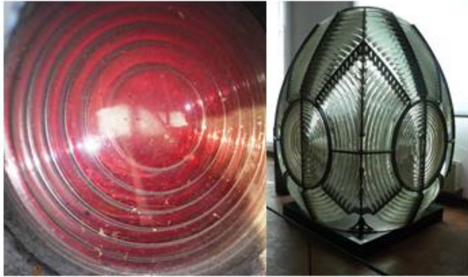
Рисунок 2.14 – Лінзи Френнеля в світлофорі та маяку
