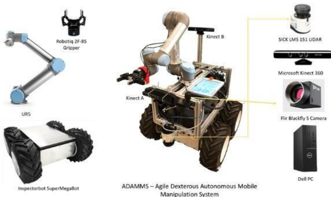
Рисунок 29 – Компоненти системи автономного мобільного робота ADAMMS.
