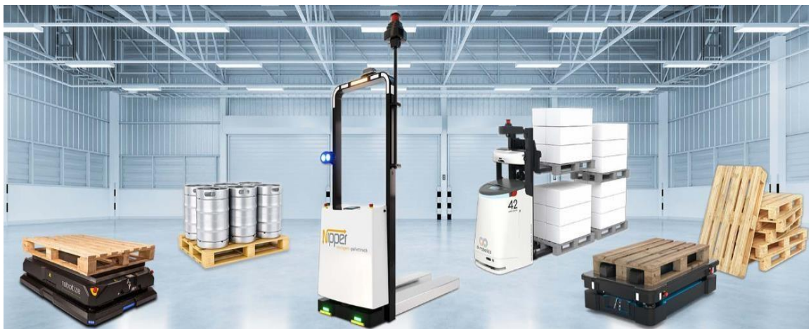
Рисунок 43 – AMR для автономного транспорту паллет intralogistics 4.0 з платформами мобільних роботів.
