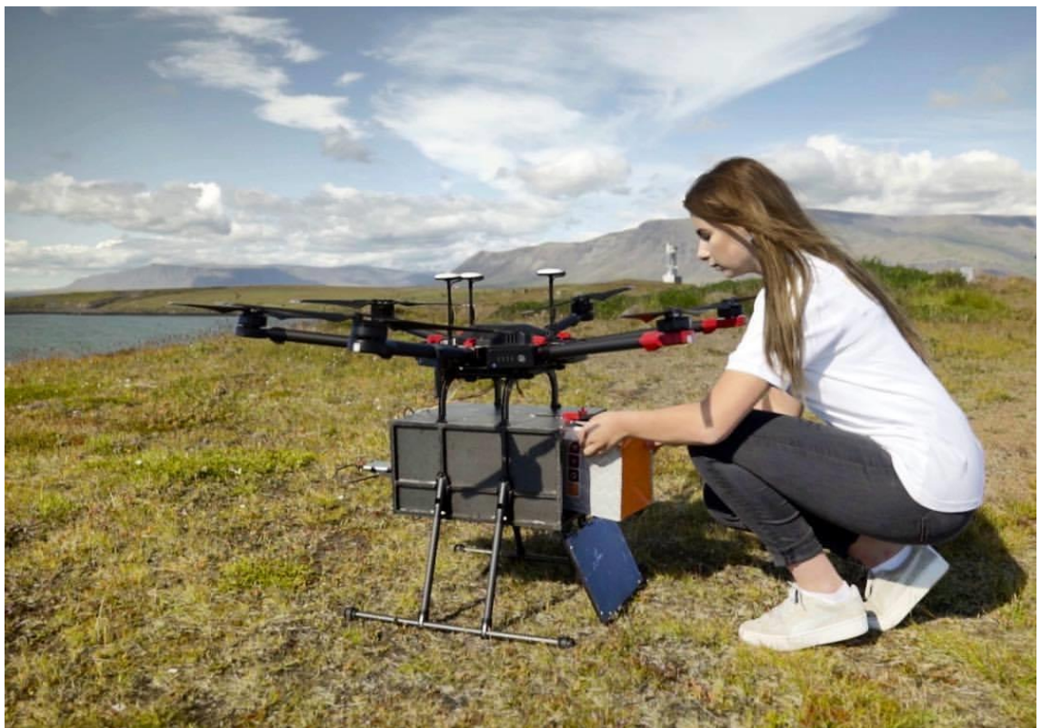
Рисунок 5 – Приклад кур'єрського дрона з закріпленням до нього контейнером
