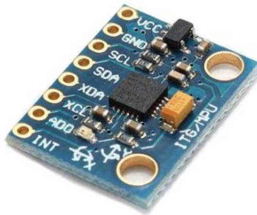
Рисунок 2.4 – Гіроскоп акселерометр Gy-521 MPU-6050
