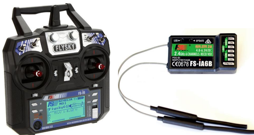
Рисунок 2.9 – Пульти радіоуправління 6ch FlySky FS-I6 та приймач FS-IA6B
