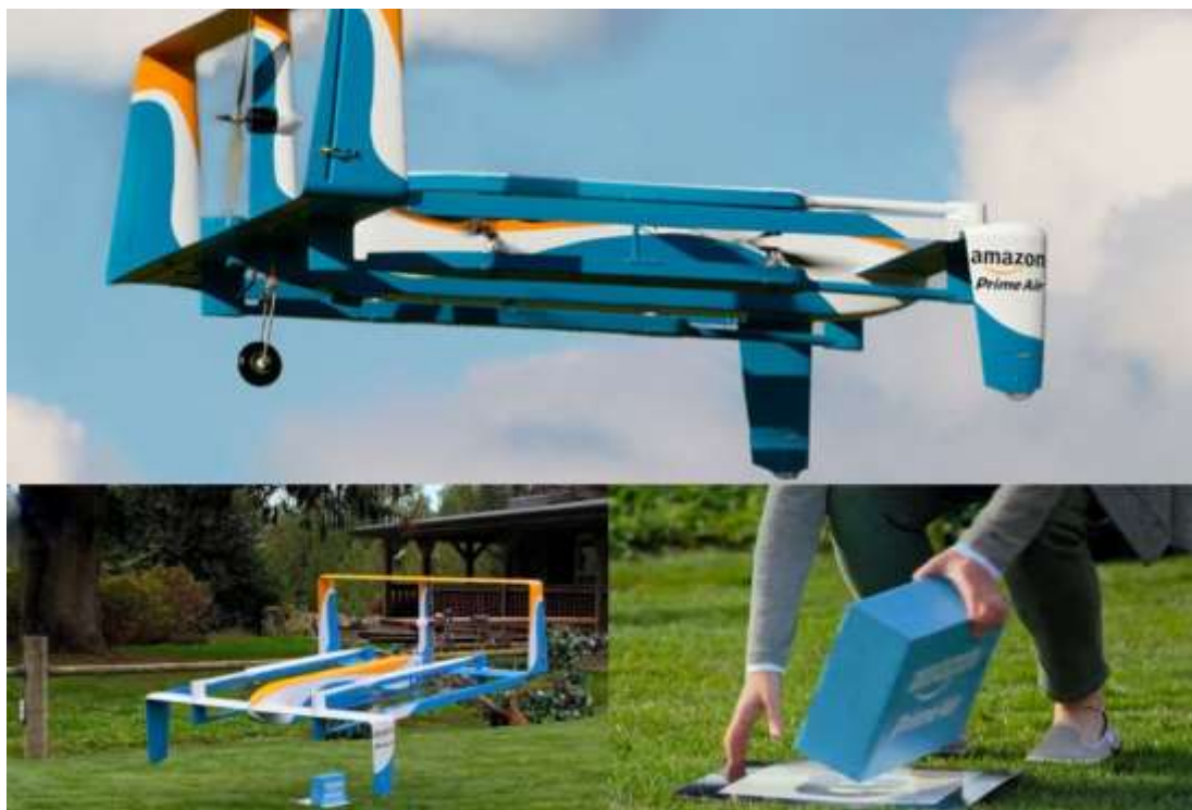
Рисунок 1.4 – Унікальний гібридний безпілотник VTOL з нерухомих крилом, який використовує Amazon Prime Air[8]
