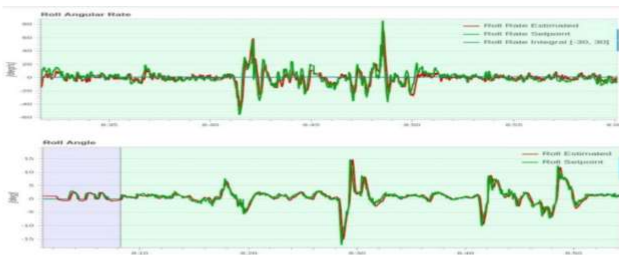
Рисунок 3.4.3 – Графік залежності бажаної та фактичної координати дрону PID-регулятора [38].
