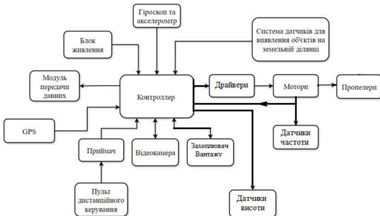
Рисунок 3.4.1 – Блок – схема системи керування побутового БПЛА
