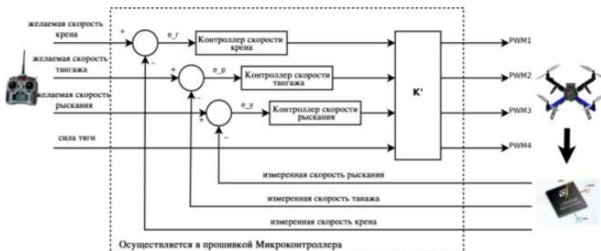
Рисунок 3.4.3 – Схема PID-регулятора дрону.
