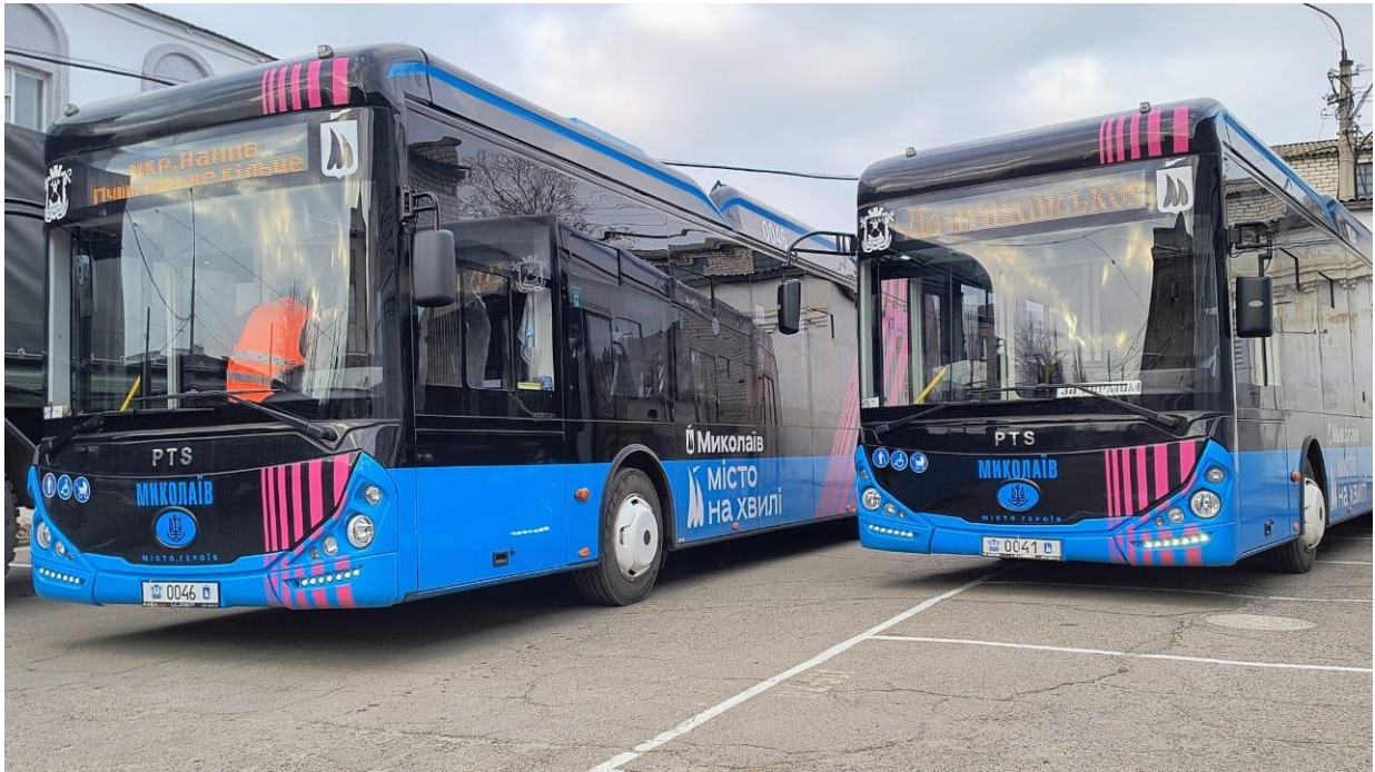
Рис. 3.3.3. Тролейбуси PTS T12309 АКІА з автономним ходом.
