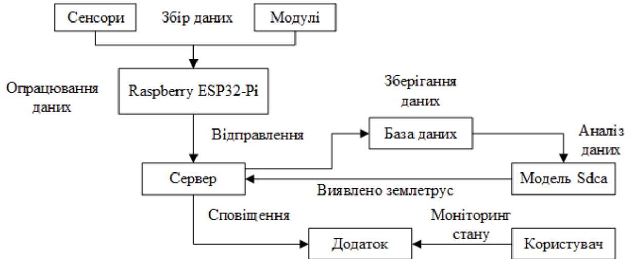
Рисунок 3.11 – Загальна схема взаємодії компонентів системи
