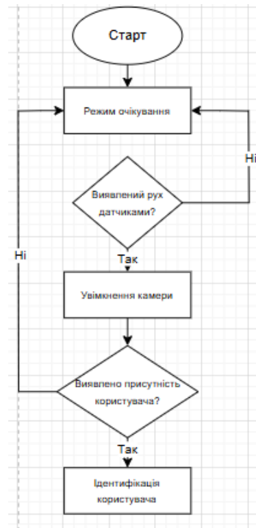
Рисунок 2.2 – Детальна блок-схема алгоритму (Блок «Виявлення присутності користувача») частина 1
