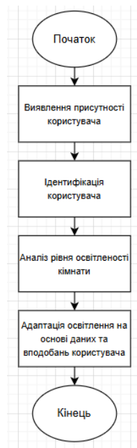
Рисунок 2.1 – Загальна блок-схема алгоритму адаптивного управління освітленням
