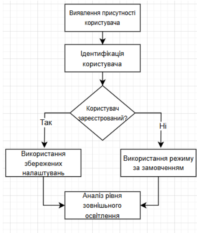
Рисунок 2.3 – Детальна блок-схема алгоритму (Блок «Ідентифікація користувача») частина 2
