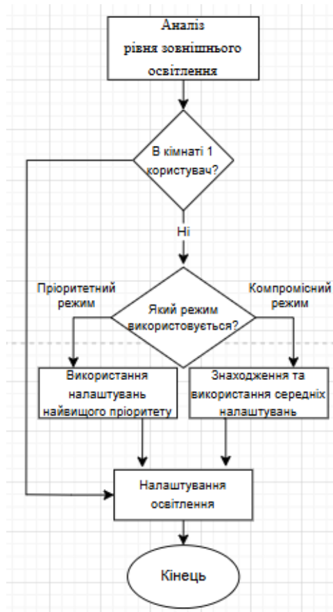
Рисунок 2.5 – Детальна блок-схема алгоритму (Блок «Налаштування освітлення») частина 4
