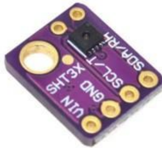
Рисунок 3.5 – Цифровий сенсор вологості та температури SHT3x
