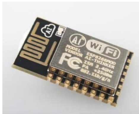
Рисунок 3.2 – Багатофункціональний Wi-Fi модуль ESP E-12
