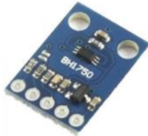
Рисунок 3.6 – Цифровий сенсор освітленості BH1750
