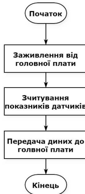
Рисунок 4.11 – Блок-схема програми датчика вологості
