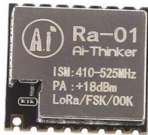
Рисунок 3.1 – LoRa Ra-01 на базі чипа SX1278
