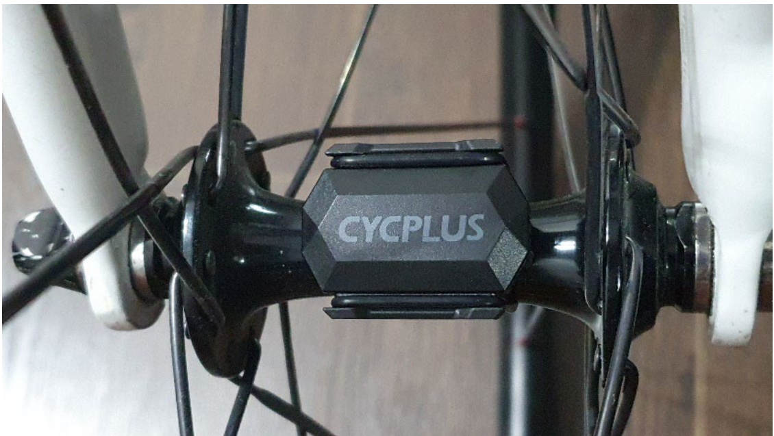
Рисунок 4.11 – Приклад закріплення датчику швидкості на втулці колеса
