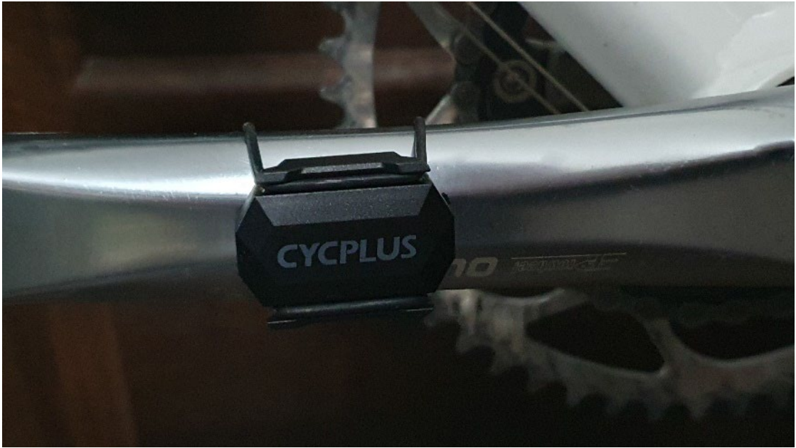
Рисунок 4.10 – Приклад закріплення датчику каденсу на шатуні
