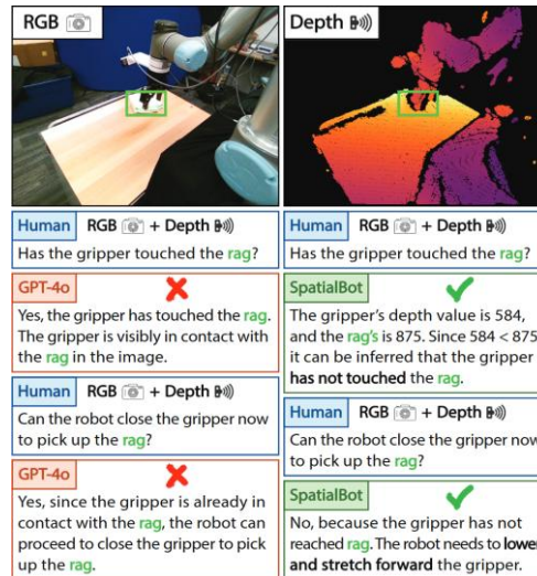
Рисунок 1.5 – Порівняння роботи моделі SpatialBot [23] та GPT-4o на просторових даних. SpatialBot [23] має кращу здатність просторового розуміння, ніж GPT-4o. З одного зображення RGB навіть людина не може судити чи зробив робот захват ганчірки.
