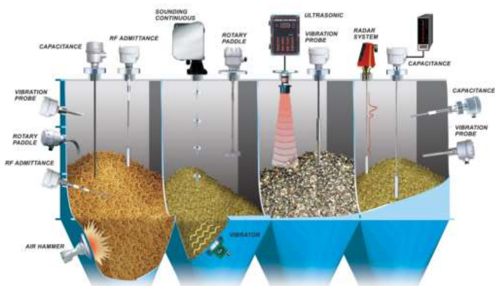
Рисунок 1.4 – Схематичне представлення поширених датчиків систем виміру рівня завантаженості бункерів [18]
