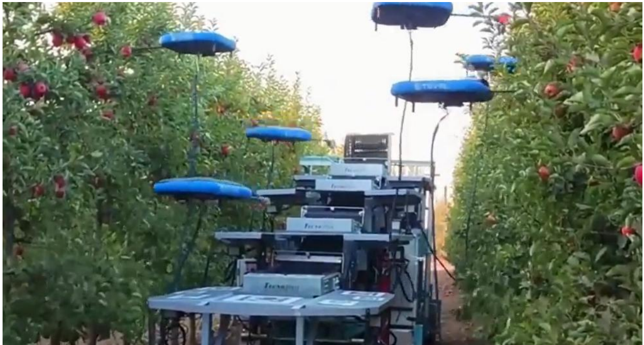
Рисунок 1.4 – Ізраїльська розробка фірми Tevel «Літаючі Автономні Роботи»
