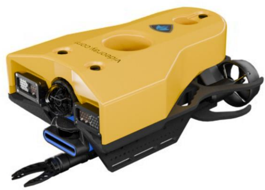
Рисунок 1.3.3 – VideoRay Pro 5 компактний апарат легкого класу призначений для інспекційних задач на малій і середній глибині
