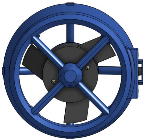
Рисунок 3.1.13 – Збірна 3D-модель вертикального рушійного пристрою, вигляд спереду
