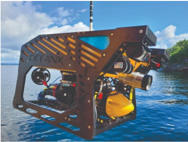
Рисунок 1.3.4 – Argus Mini ROV версія з відеокамерою 4К
