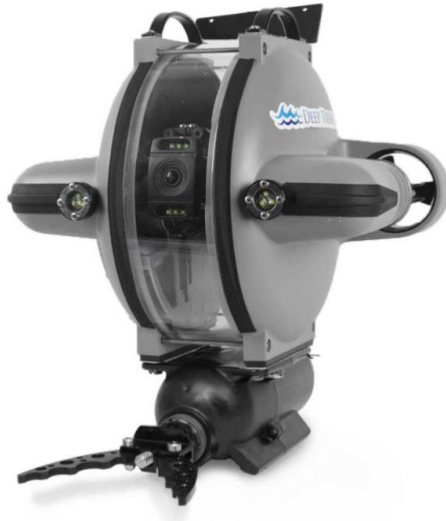
Рисунок 1.3.5 – Deer Trekker DTG3 — легкий, портативний апарат зі змінним вектором руху
