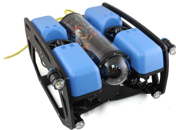
Рисунок 1.3.1 – BlueROV2 компактний оглядовий ROV зі структурованим корпусом і вертикальними рушіями
