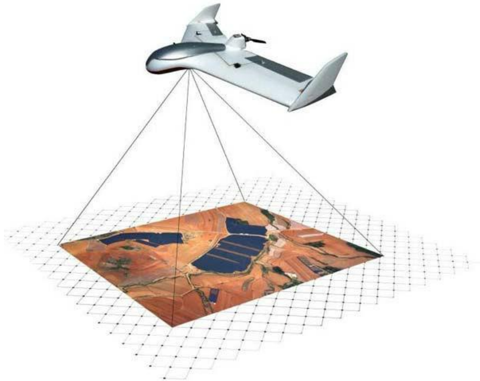
Рис.2.2.2. – Схема методу аерофотознімання
