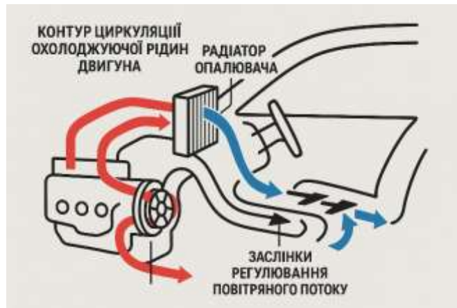
Рисунок 1.4 - Схема системи опалення автомобіля
