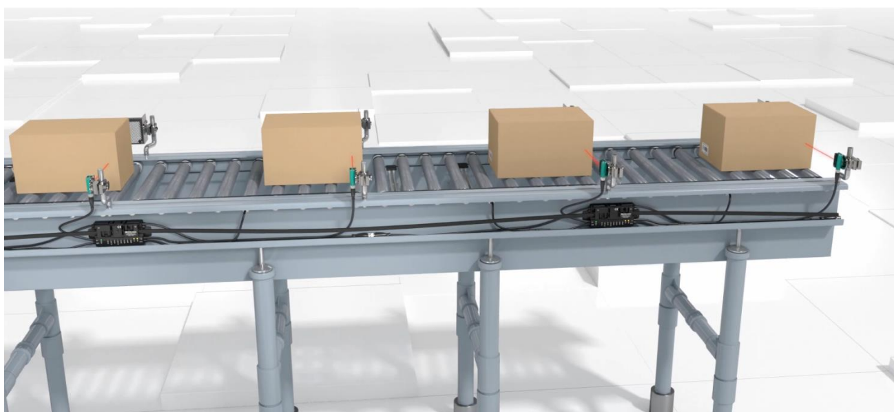
Рисунок 2.3 – Реалізація ZPA-логіки на вихідних конвеєрах
