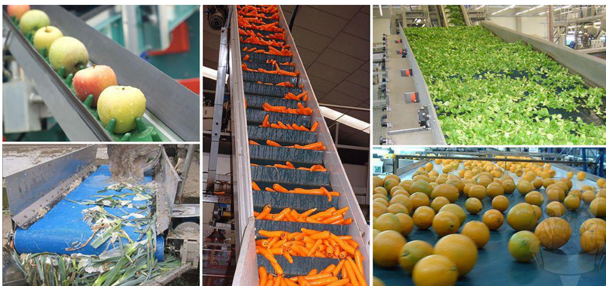
Рисунок 1.2 – Типи застосовуваних конвеєрів: стрічкові, ковшові та сортуючі
