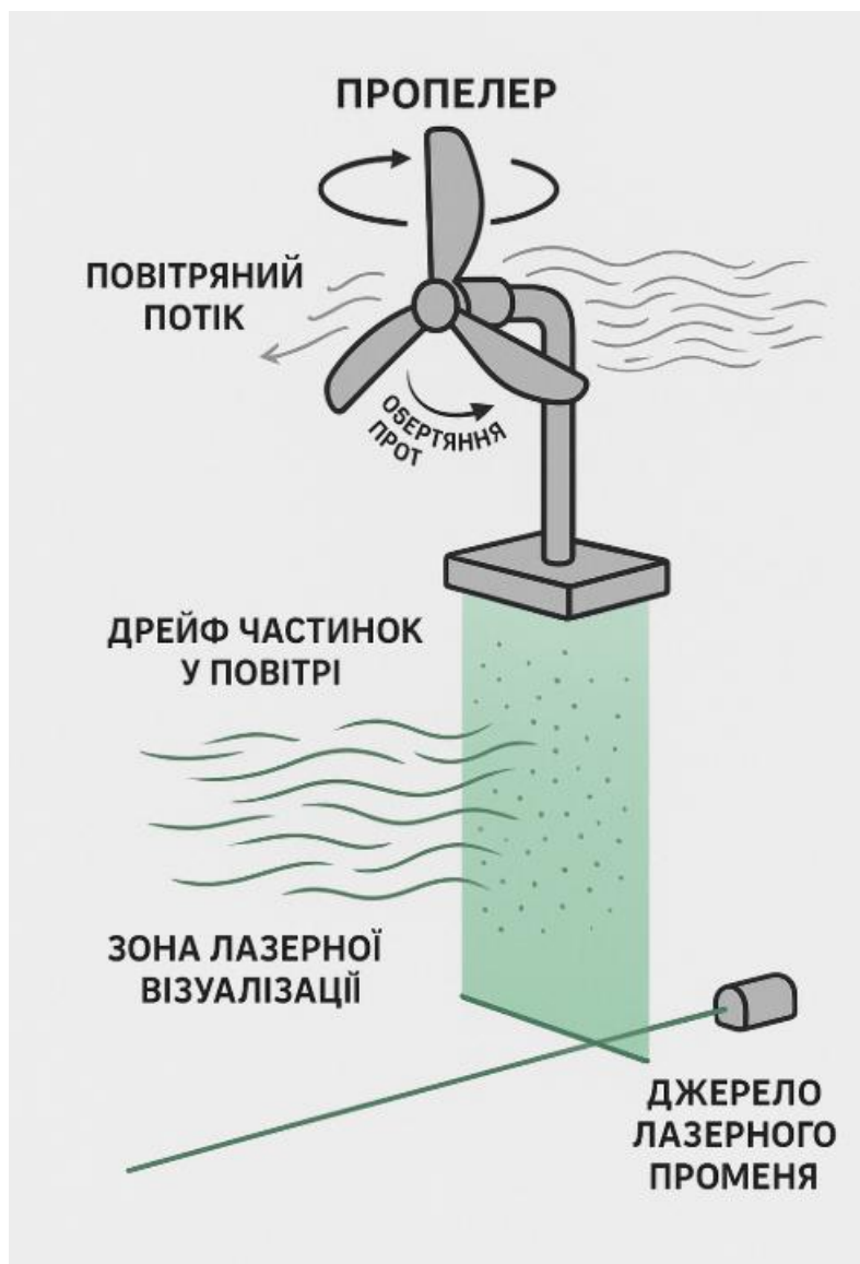
Рисунок 1.9 – Візуалізація повітряного потоку за пропелером дрона з лазерною підсвіткою.
