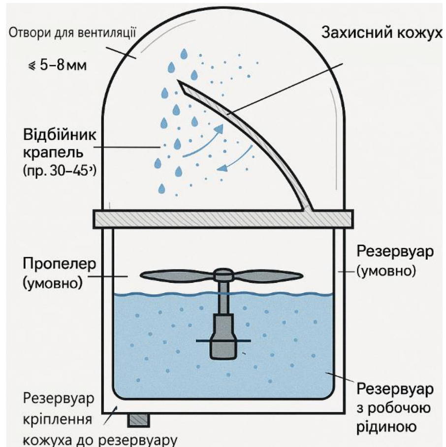
Рисунок 5.2 – Захисний кожух резервуару з відбійником крапель
