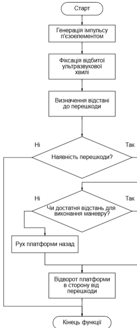
Рисунок 3.5 – Функціональна схема алгоритму оминання перешкод
