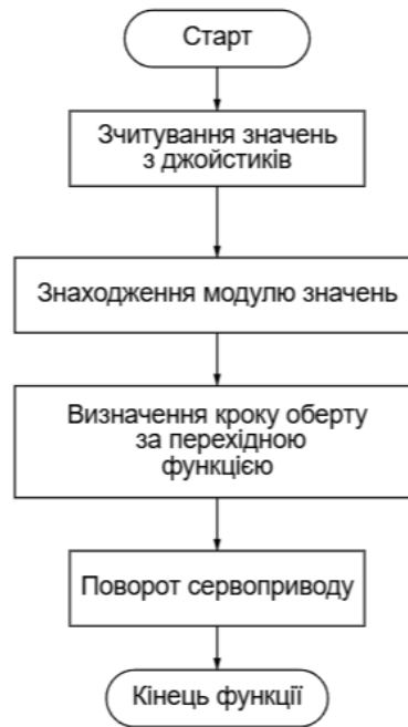
Рисунок 3.19 – Функціональна схема алгоритму перехідного процесу керування сервоприводами
