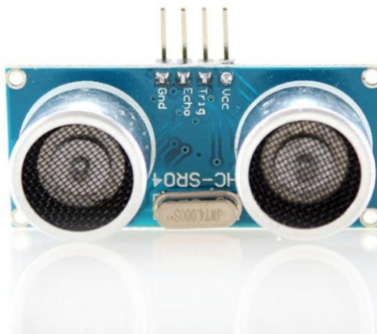
Рисунок 3.1 – Ультразвуковий датчик відстані HC-SR04 [19]
