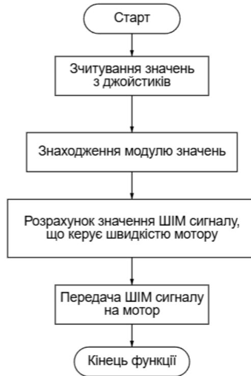
Рисунок 3.22 – Функціональна схема алгоритму перехідного процесу системи керування моторами постійного струму
