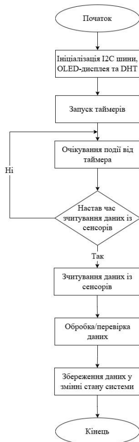
Рисунок 2.11 – Блок-схема алгоритму подій від сенсорів у системі
