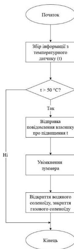
Рисунок 2.2 – Алгоритм роботи пристрою з термодатчиком
