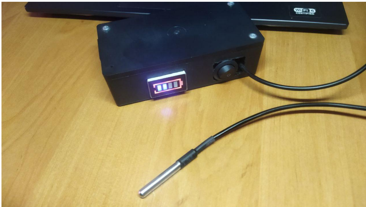
Рисунок 3.4 – Розташування OLED-дисплею у корпусі пристрою
