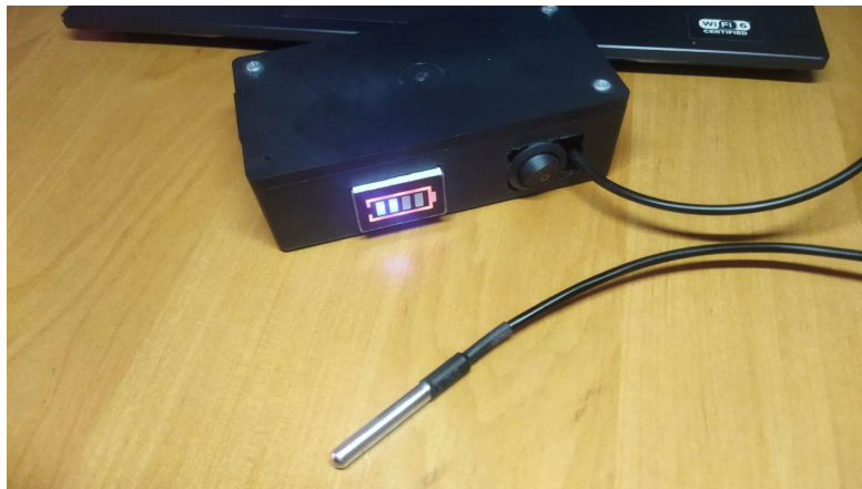
Рисунок 3.15 – Зовнішній вигляд пристрою з увімкненим OLED-дисплеєм та сенсором температури DS18B20
