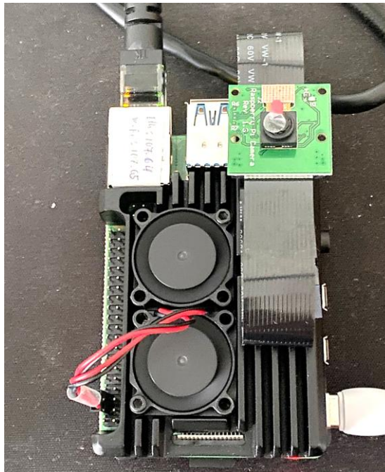
Рисунок 3.4 – Підключення Raspberry Pi 4 Model B для подальшого налаштування
