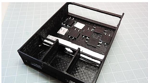
Рисунок 3.6 – Процес друку корпусу портативного ігрового пристрою
