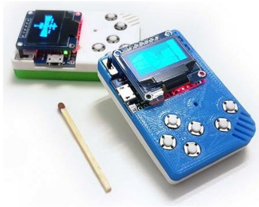
Рисунок 1.2 – Мінімалістична DIY ретро-консоль на базі Arduino [1]
