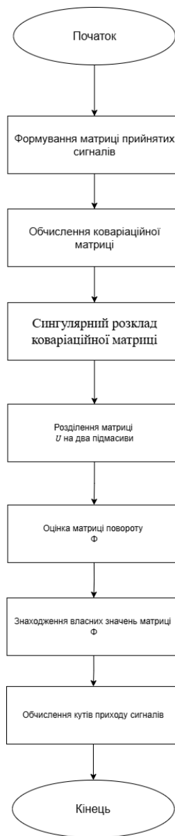
Рисунок 2.6 – блок-схема роботи алгоритму ESPRIT
