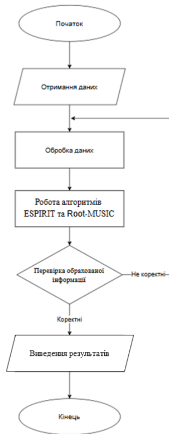
Рисунок 2.3 – блок-схема архітектури програмної системи
