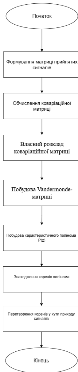
Рисунок 2.4 – блок-схема роботи алгоритму Root-MUSIC
