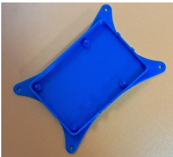
Рисунок 3.15 – Надрукований елемент основи для одноплатного комп'ютера
