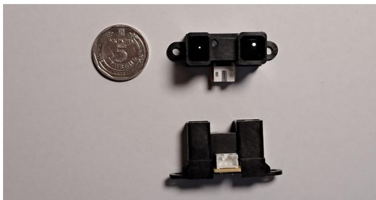
Рисунок 2.3 – Зображення ІЧ-датчику моделі Sharp GP2Y0A02YK0F
