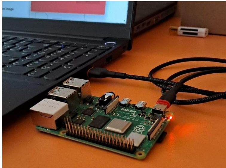
Рисунок 3.2 – Підключення Raspberry Pi 5 до ноутбука
