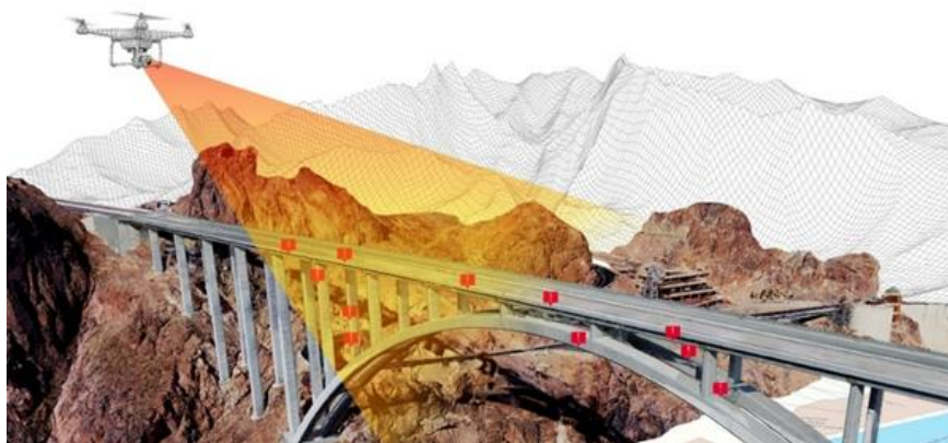
Рисунок 1.4 – Візуалізоване зображення принципу застосування БПЛА для моніторингу стану конструкції моста компанією «Manam Applications»
