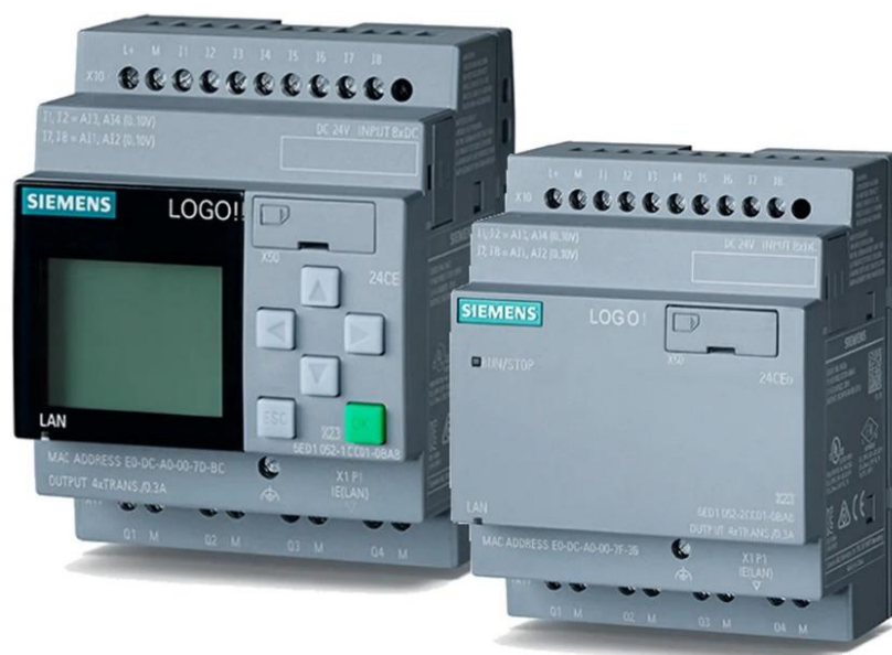
Рисунок 1.4 – Логічний модуль Siemens LOGO!8 LOGO!12/24RCE 12/24 VDC, реле, 8 DI / 4 DO [25]
