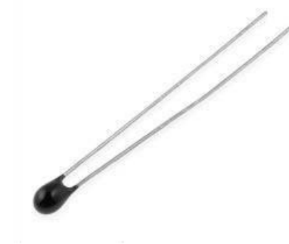
Рисунок 2.6 – Аналоговий сенсор вологості ґрунту та термістор NTC [15]
