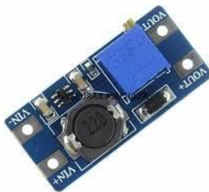
Рисунок 2.16 – Підвищувачий модуль MT3608 [10] для стабілізації живлення системи
