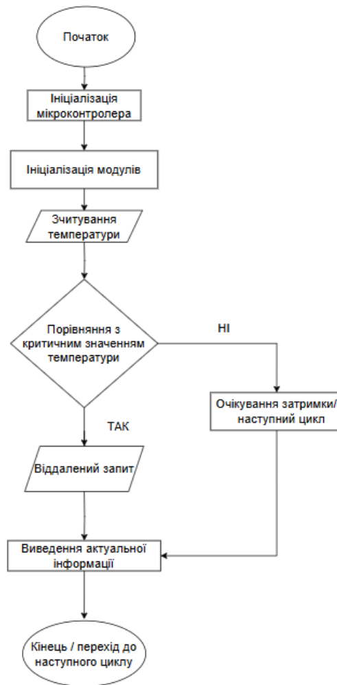
Рисунок 1.1 – Блок-схема логіки функціонування системи GardenSens
