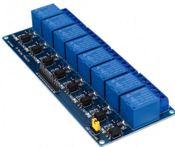
Рисунок 2.7 – Модуль реле на 8 канали з оптоізоляцією, що використовується для керування навантаженням у системі GardenSens [28]
