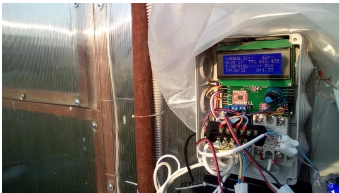
Рисунок 4.1 – Прототип системи GardenSens під час тестування в умовах теплиці
