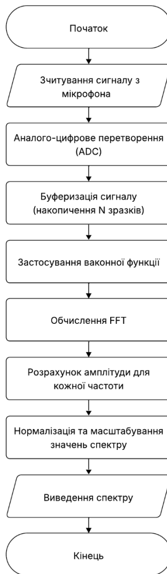
Рисунок 1.9 – Блок-схема аналізатора спектру FFT
