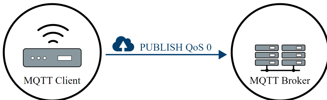
Рисунок 2.4 – Схема роботи QoS 0 [5]
