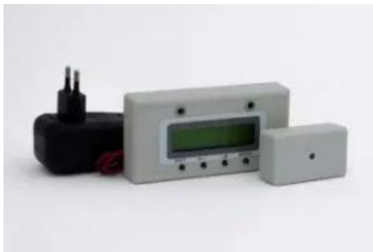
Рисунок 1.3 – Лічильник відвідувачів ТК-02, інфрачервоний сенсорний пристрій для підрахунку людей у приміщенні [19]
