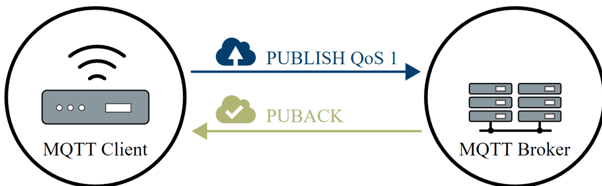
Рисунок 2.5 – Схема роботи QoS 1 [5]
