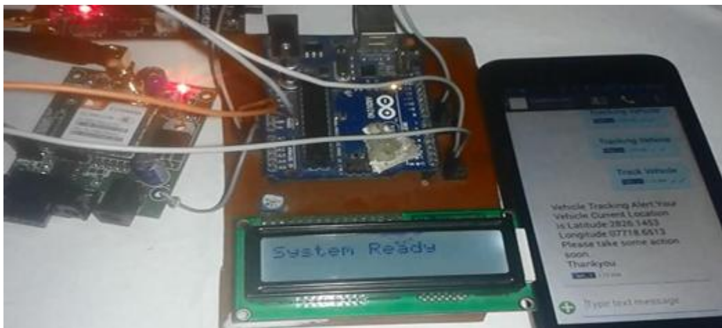
Рисунок 1.4 – Система оповіщення з LCD, GSM, GPS і передачею координат [18]
