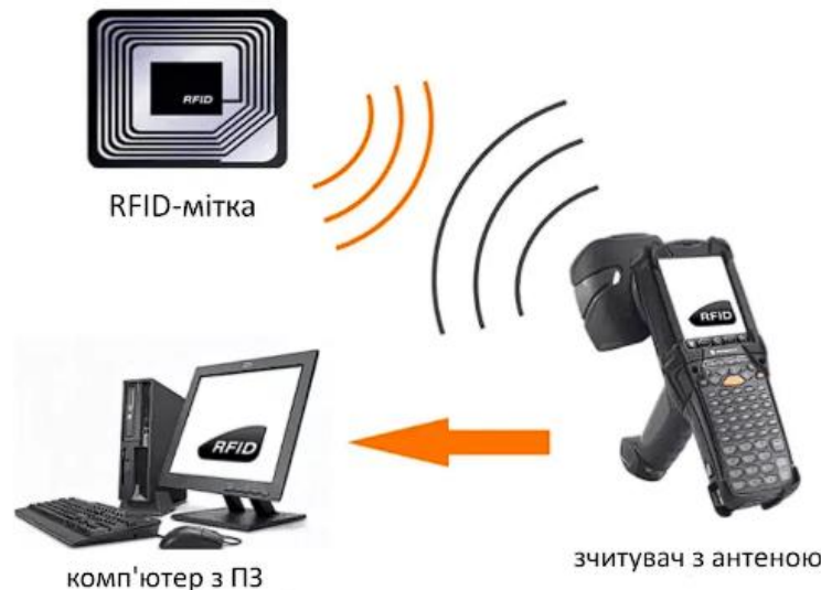
Рис. 1. Схематичне зображення складових RFID та їх взаємодія
