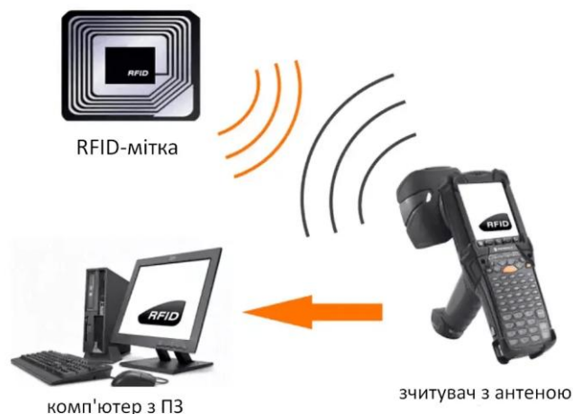
Рисунок 1.1 – Схематичне зображення складових RFID та їх взаємодія [6]
