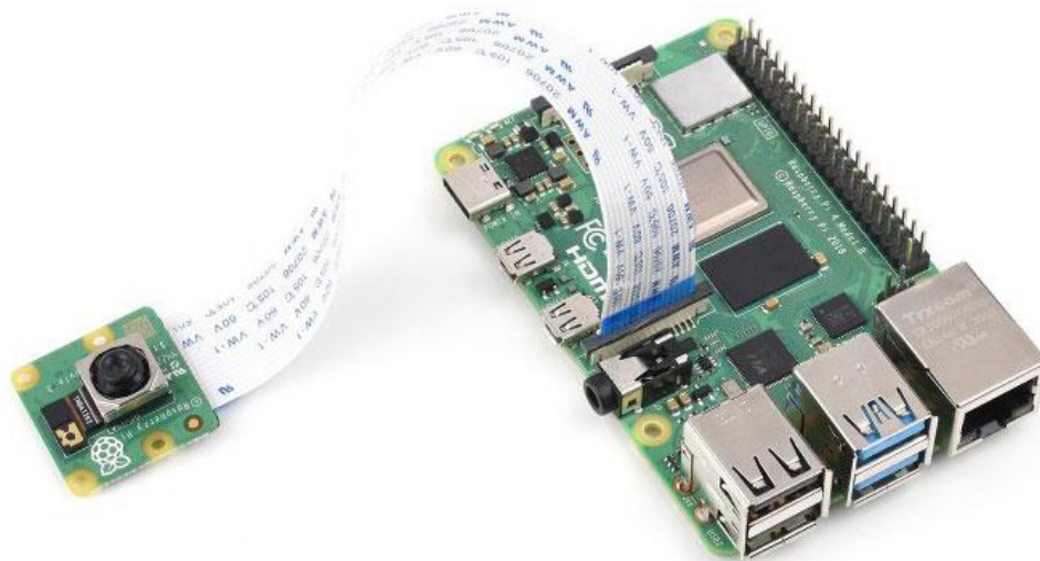
Рис. 2.9 – Модуль ширококутної камери 12МП IMX708 разом з Raspberry Pi
