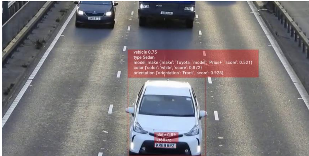
Рисунок 3.8 – Система комп'ютерного зору для виявлення транспортних засобів, зчитування номерних знаків і надання інформації про марку автомобіля, колір, тип і положення
