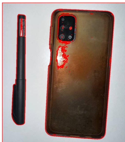
Рисунок 2.2 – Результат виконання функцій пошуку та нанесення контурів на вхідне зображення
