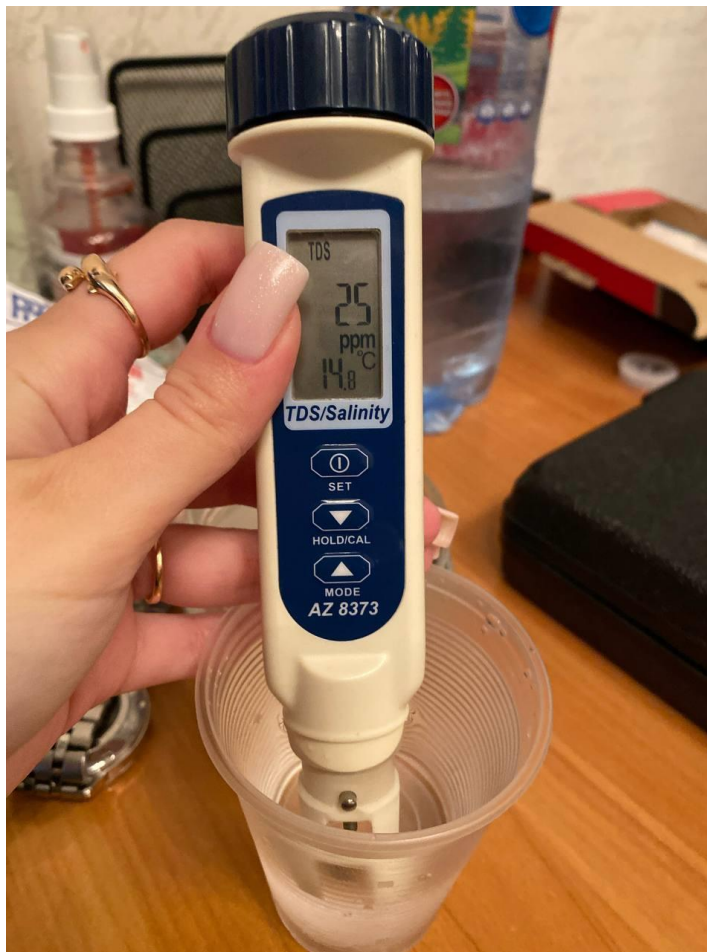
Рис. 3.1. Портативний електронний прилад – TDS-метр AZ 8373
