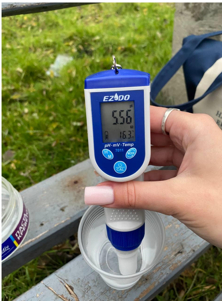
Рис. 3.2. Портативний електронний прилад – рН-метр EZODO 7011
