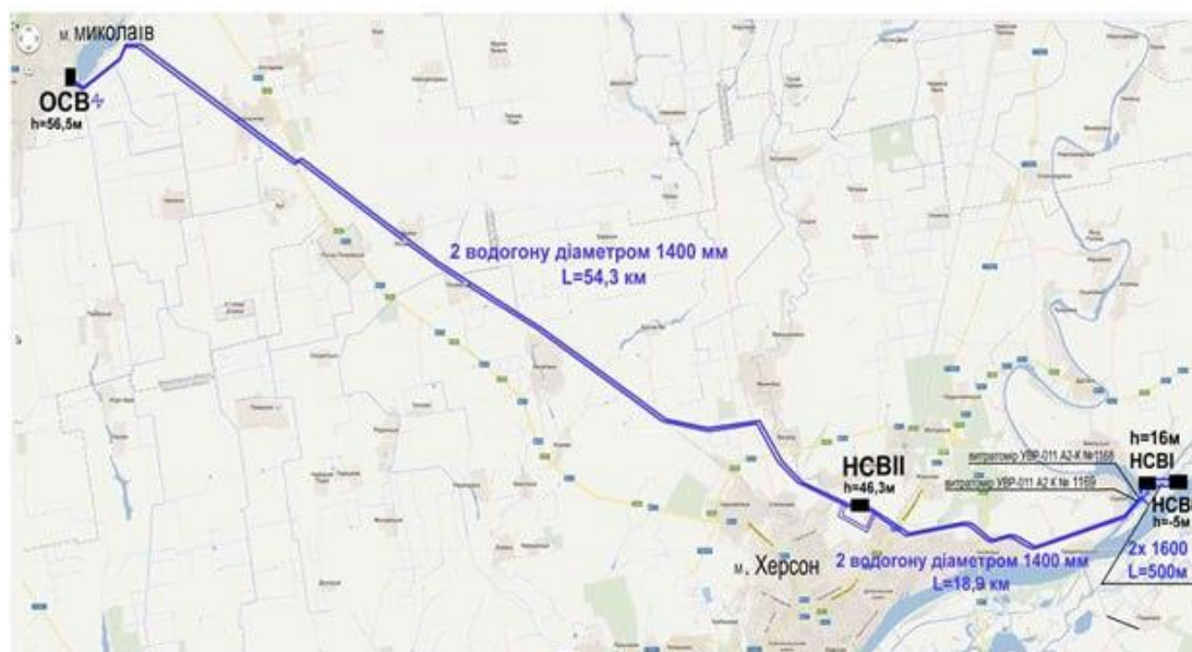
Рис. 1.1 Схема постачання води у м. Миколаїв магістральним водогоном «Дніпро–Миколаїв»
