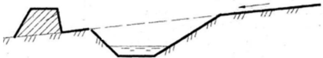
Рис. 2.9. Водовідвідний («нагорний») вал-канава
