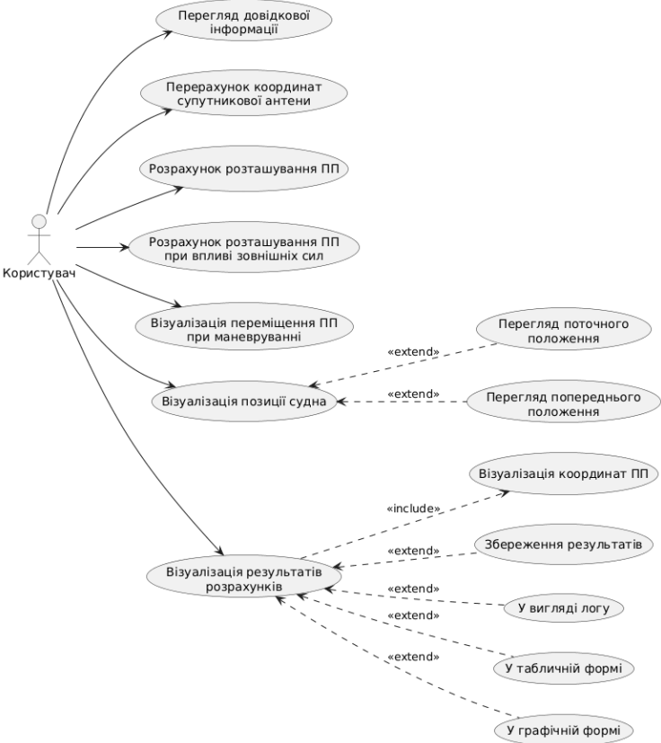
Рисунок 3.2 – Діаграма варіантів використання програмного забезпечення
