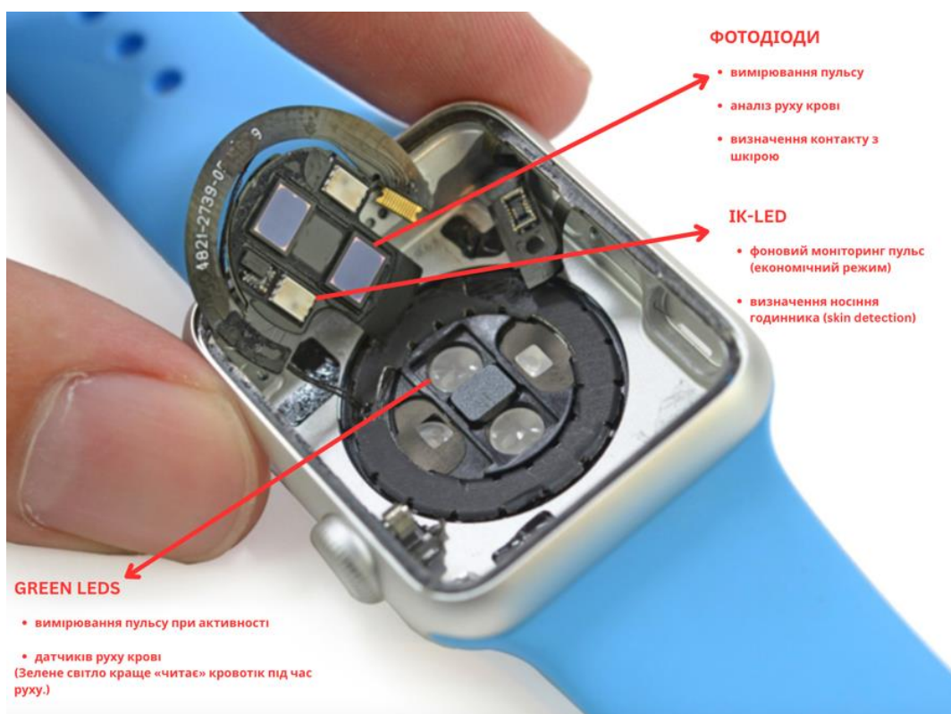
Рисунок 2.5 – Сенсори смарт-годинника для зчитування фізіологічних параметрів користувача
