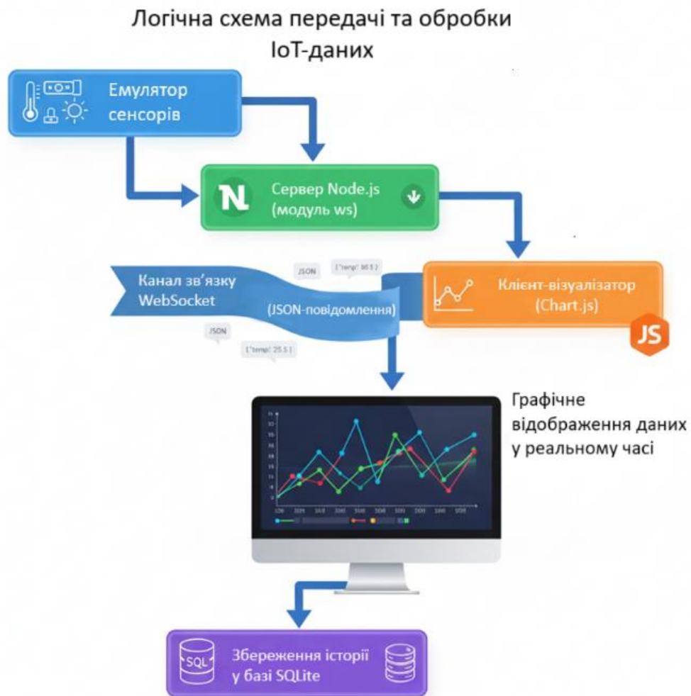
Рисунок 2.2 – Логічна схема передачі та обробки IoT-даних
