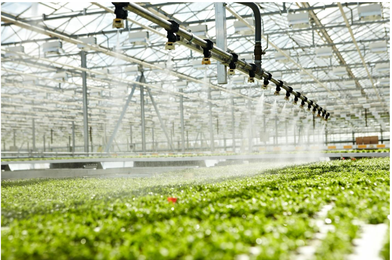
Рисунок 1.5 – Приклад системи з використанням стріли для поливу [6]
