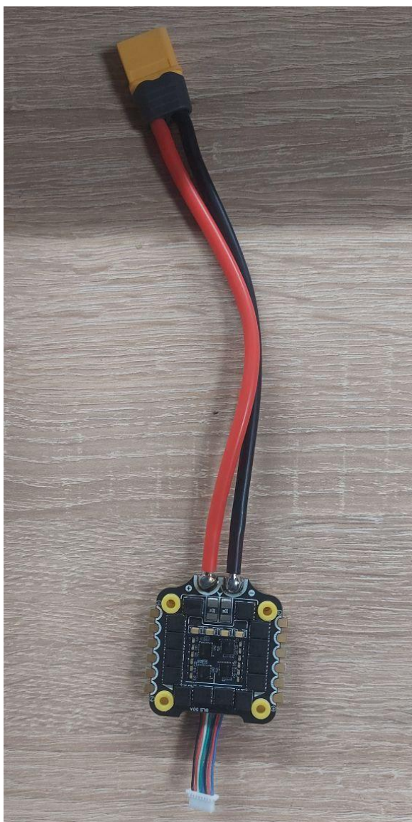
Рисунок 2.5 – Напаяний силовий кабель з конектором XT60
