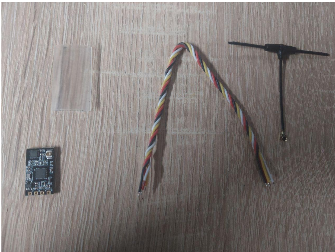
Рисунок 1.4 – ESP 8285 Betafrv 2.4 Nano RX
