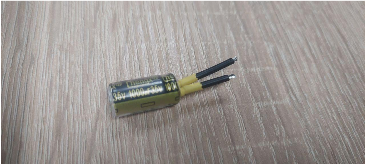
Рисунок 2.4 – Заводський конденсатор стеку Speedybee F405
