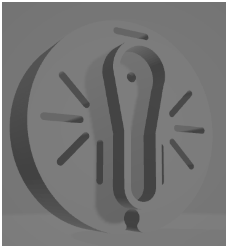
Рисунок 2.27 – Модель дискового механізму скиду вантажа
