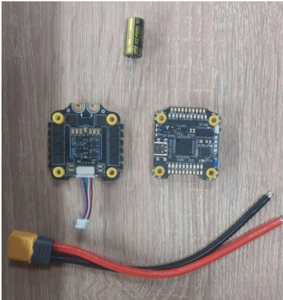
Рисунок 1.3 – Стек Speedybee F405 V3
