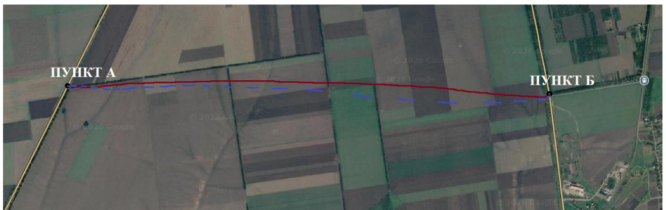
Рисунок 2.1. Оглядова схема району вишукувань та попередні варіанти трасування осі дороги
