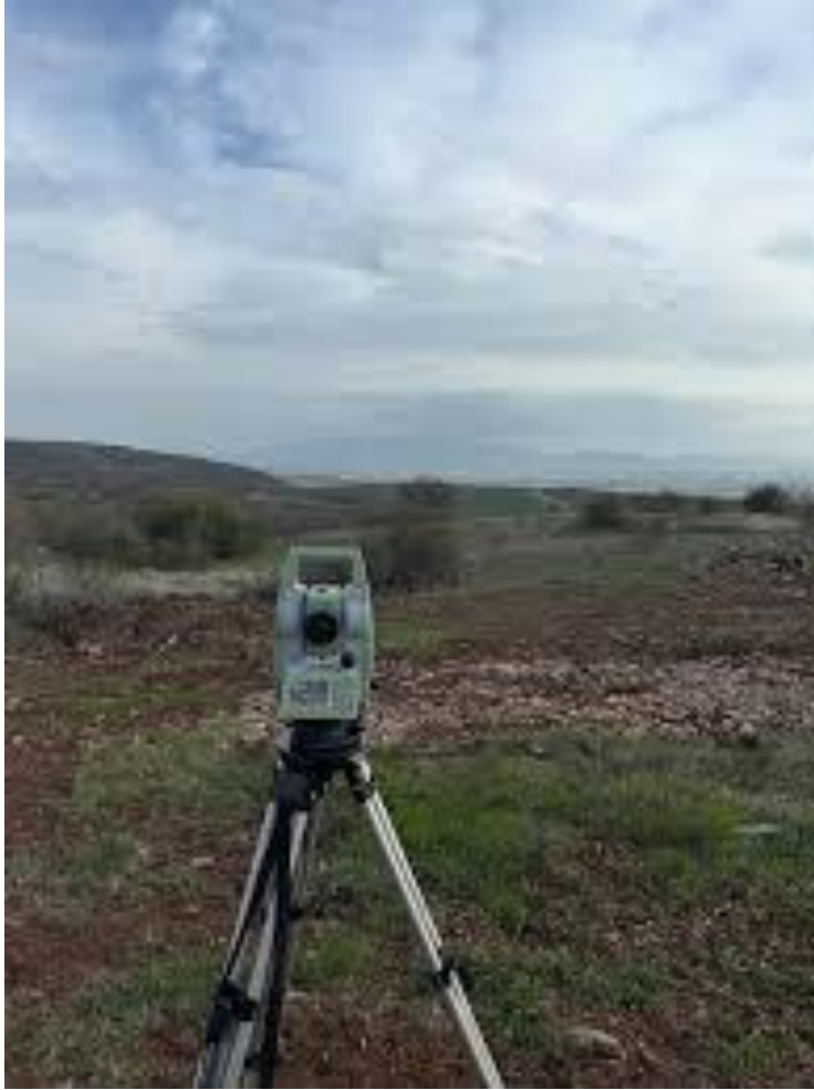
Рисунок 2.3. Електронний тахеометр на геодезичній станції під час виконання вимірювань на відкритій місцевості
