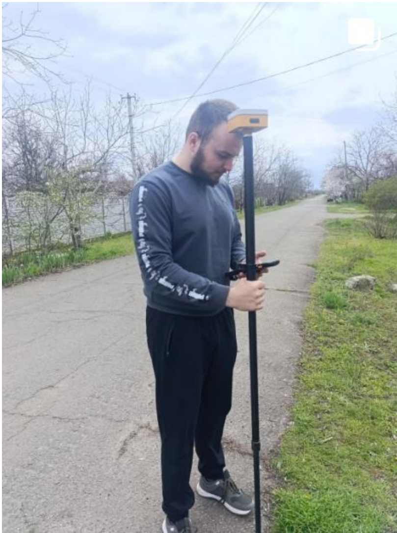
Рисунок 2.4. Робота з GNSS-приймачем у режимі RTK під час зйомки характерних точок траси
