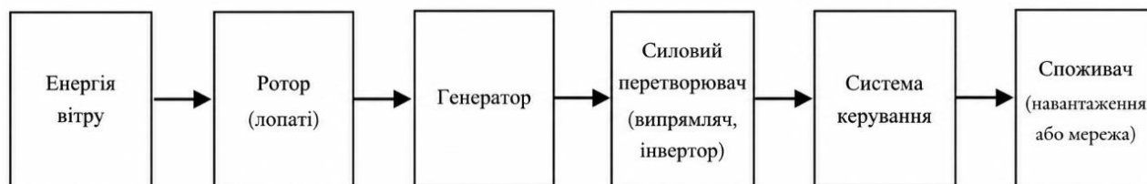
Рисунок 1.5 – Структурна схема перетворення енергії у вітроелектричній установці (розроблена автором КБР)
