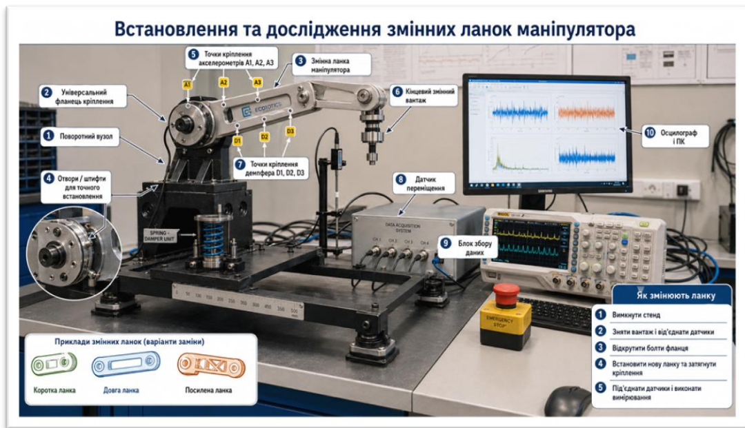
Рисунок 3.2 – Встановлення та дослідження змінних ланок маніпулятора
