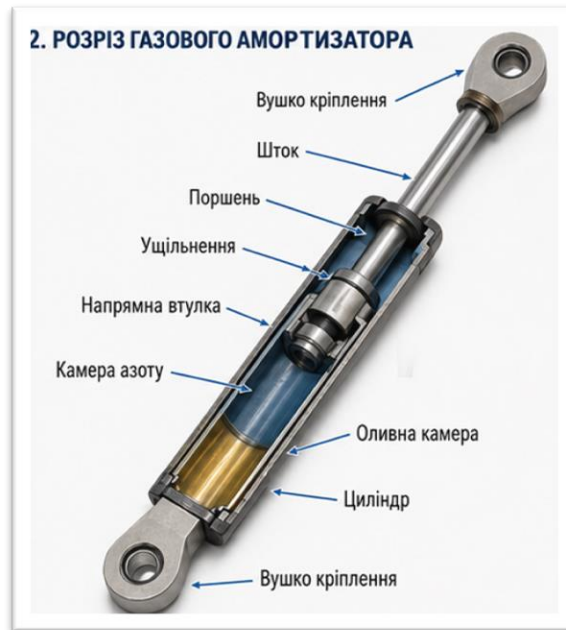
Рисунок 4.2 – Газовий амортизатор маніпулятора та його елементи
