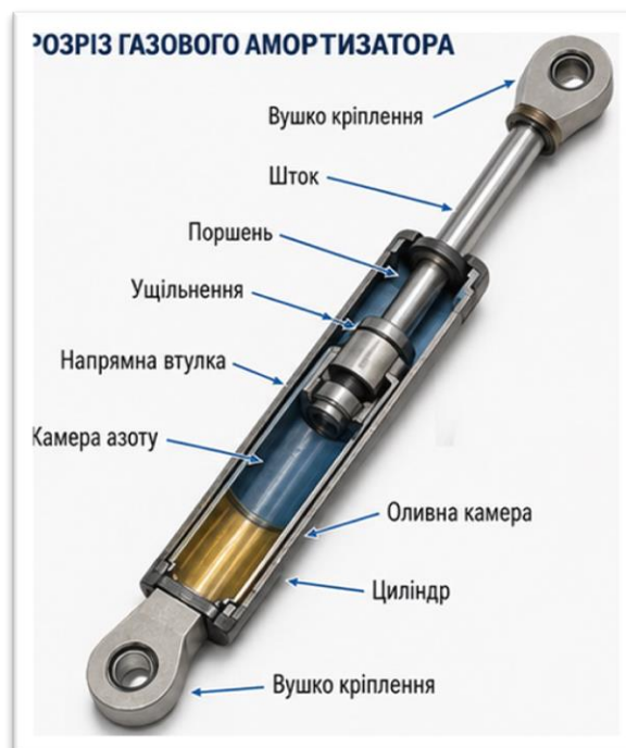
Рисунок 2.4 – Газовий амортизатор на ланці маніпулятора та його розріз
