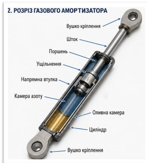
Рисунок 3.3 – Модель газового амортизатора з розрізом та орієнтовними розмірами
